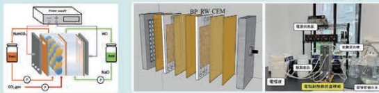
圖2、本計畫已開發以電透析為基礎應用電化學酸鹼震盪 (pH Swing) 進行沼氣二氧化碳捕捉
