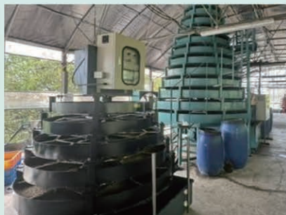
圖、建立大小不同的黑水虻自動化飼養機器
