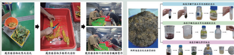
圖三：(A)鳳梨纖維製作流程建立；(B)海藻多醣萃取流程建立。
