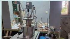
圖1 自行設計製作之熱裂解實驗系統
