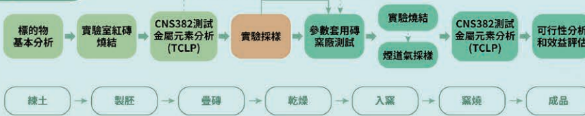
圖2 實廠製磚流程圖
