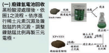
圖1. 廢鎳氫電池回收再製三元電極流程。
